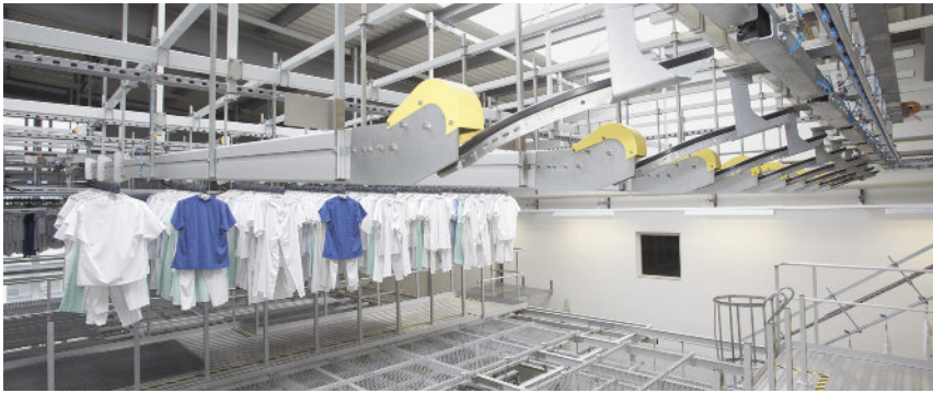
Ein Sortiersystem mittels RFID-Technologie an Bügeln und Textilien sortiert die Berufsbekleidung automatisch für die Kunden.
